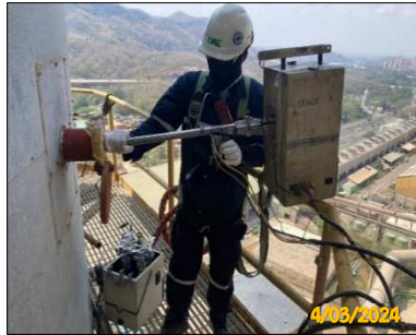
รูปที่ 3-12 การตรวจวัดคุณภาพอากาศ จากปล่องของโรงงานปูนฯ บริเวณ Main Stack ของสายการผลิตที่ 4
